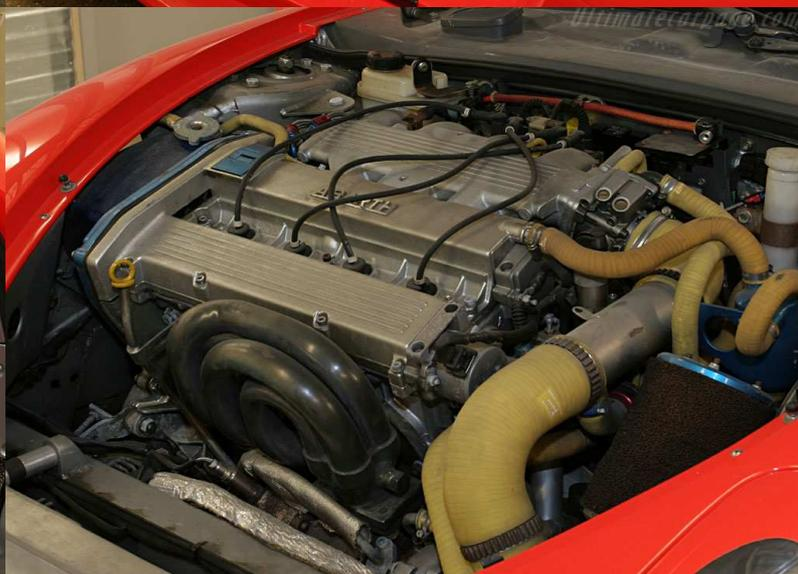
Optional di serie: Motore 2 litri turbo derivante da quello della Lancia "Delta Integrale" erogante ben 330 CV a 6500 giri montato in posizione anteriore trasversale; Dischi freno autoventilati marca Brembo derivanti da quelli della Ferrari "F50"; Pneumatici Good Year "Eagle F1" 265/35 ZR 18 avanti e dietro; i cerchi in lega leggera di alluminio sono stati disegnati appositamente per questa vettura dalla "OZ Racing" nella misura 10x18 pollici;
