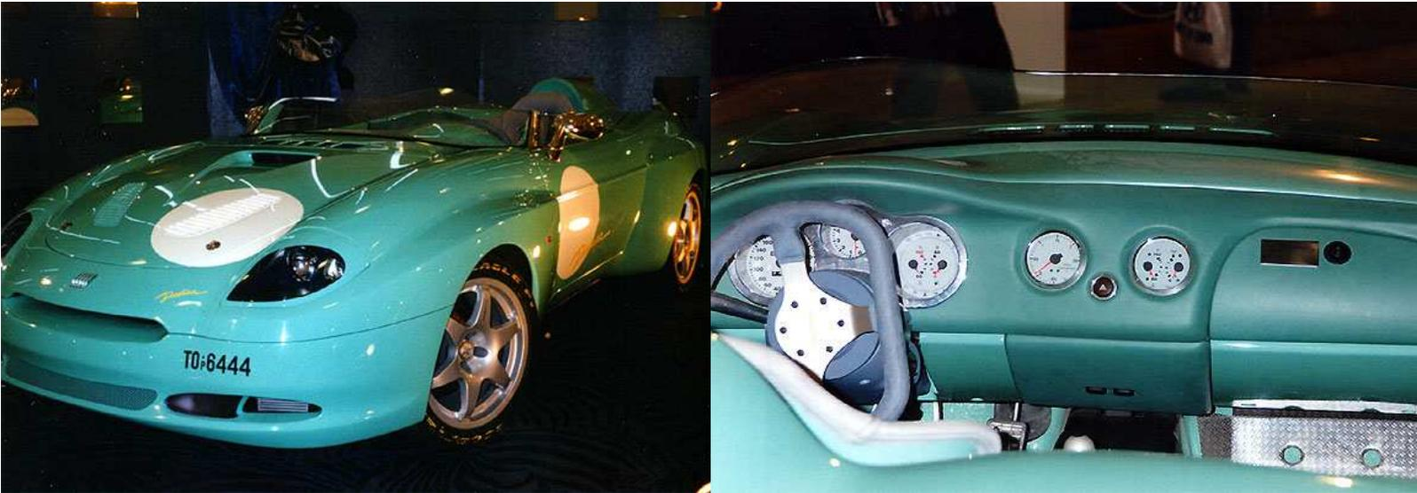
Optional di serie: Motore 2 litri derivante da quello del “Coupè” 16 Valvole Turbo sviluppante 262 CV; Volante, pedali e sedili in pelle turchese marca Momo; Cerchi in lega a 6 razze marca Tecnomagnesio; Freni autoventilati marca Brembo; Ruote Goodyear Eagle F1’S; Vernice di color turchese; Specchietti retrovisori cromati; Presa d’aria sul cofano anteriore; Fari cigliati; Roll bar singolo dietro il sedile guidatore;
